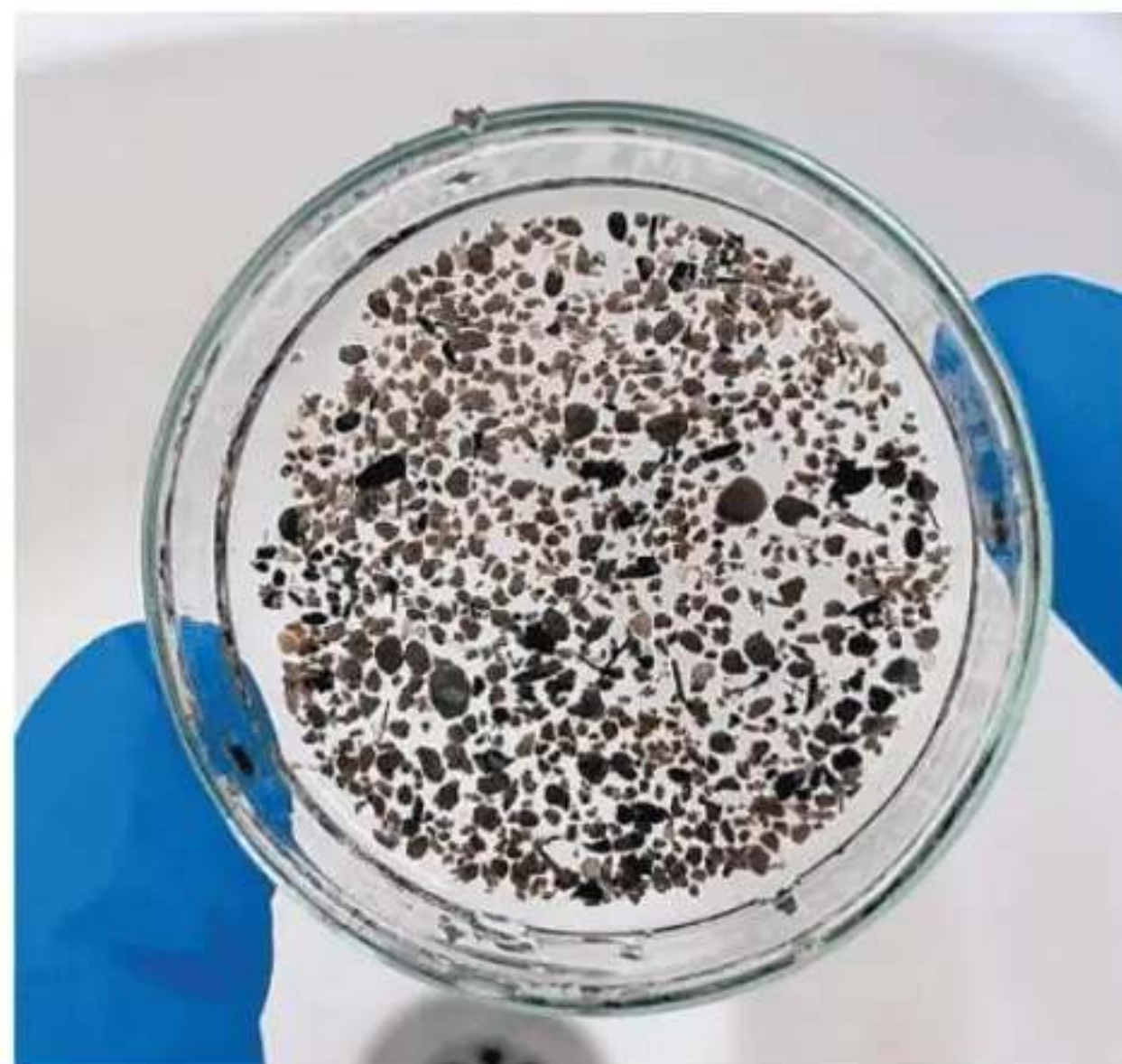
Biomasa granular formada en la EDAR de Moaña
